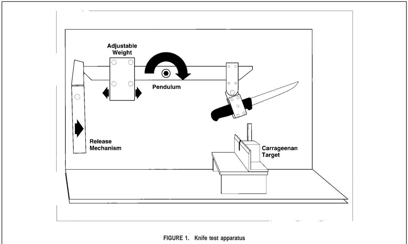
FIGURE 1. Knife test apparatus
